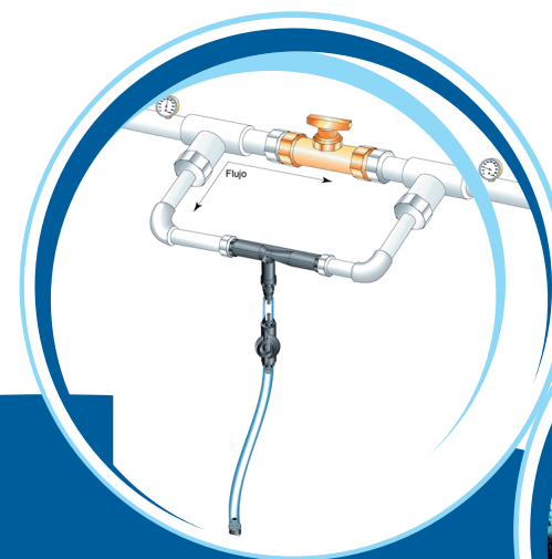
inyector Venturi en bypass
