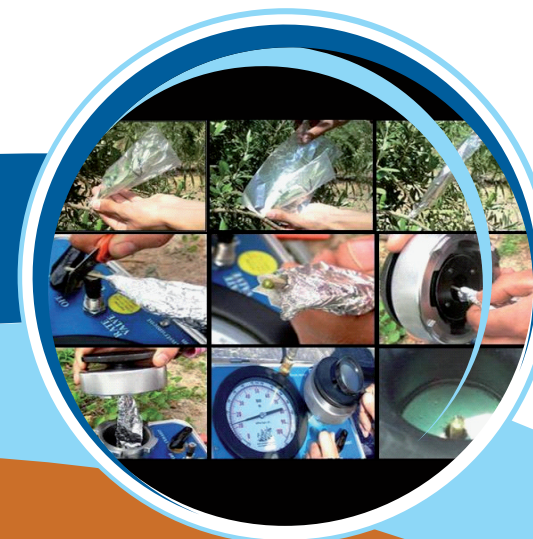
Figura 3. Mediciones del Potencial de xilema al mediodía.
