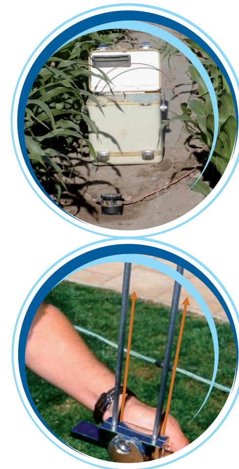
Figura 1. TDR y varillas por donde viaja el impulso.
